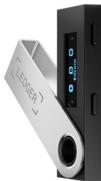
Slika 3. Primjer hardware novčanika kriptovaluta Ledger wallet
