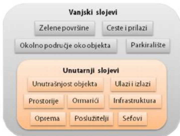
Slika 4. Prikaz slojevite fizičke zaštite
