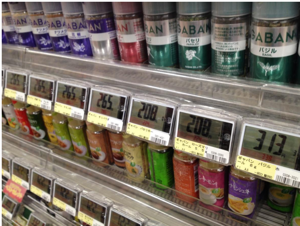
Slika 4. Elektronička pločica sa istaknutom cijenom na LCD ekranu (ESL)
